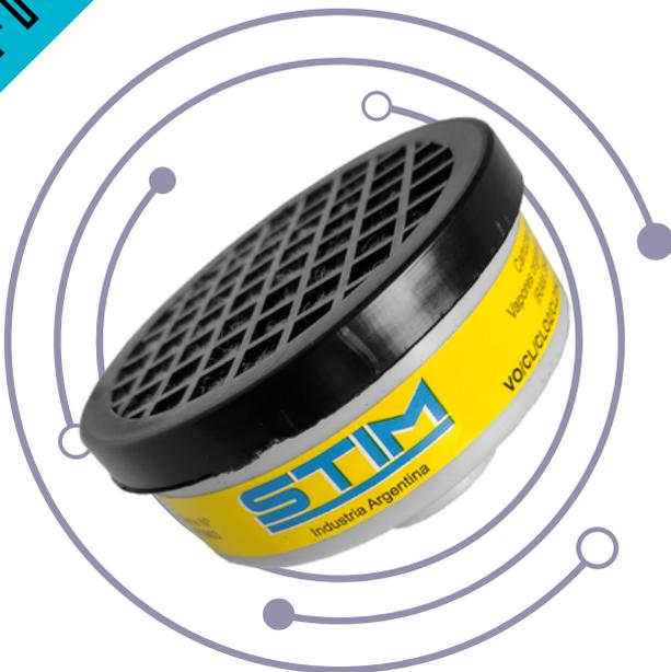
Los cartuchos STIM F3003 están diseñados para las medias máscaras series S1100, S1200 y la máscara de cara completa C5200, protegiendo contra vapores orgánicos y gases ácidos. Proveen protección hasta 10 veces el límite de exposición permitido (PEL) con medias máscaras y hasta 50 veces el PEL con máscaras completas. Su base centrada asegura que el aire atraviese uniformemente todas las capas de carbón activado, extendiendo la vida útil de los filtros.
